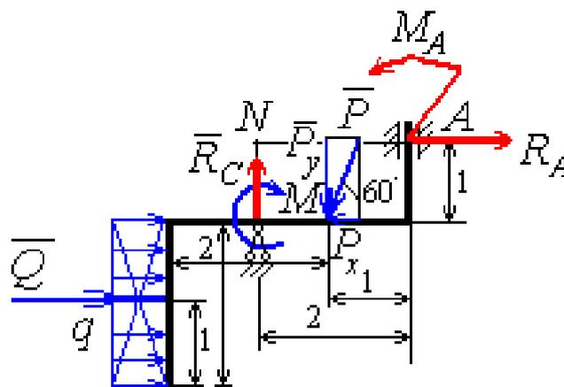
Чтобы исключить две неизвестные реакции  $R_A$  и  $R_C$ , составим уравнение моментов относительно точки  $N$  (в этой точке пересекаются линии действия этих сил):
