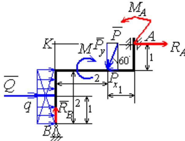
Чтобы исключить две неизвестные реакции  $R_A$  и  $R_B$ , составим уравнение моментов относительно точки  $K$  (в этой точке пересекаются линии действия этих сил):
